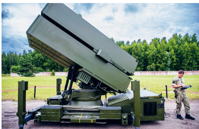
4.30 pav. | Oro erdvės gynybos sistema NASAMS, naudojama nuotoliniu būdu valdomiems orlaiviams ir sparnuotosioms raketoms, sraigtasparniams, lėktuvams ir kitiems taikiniams naikinti
