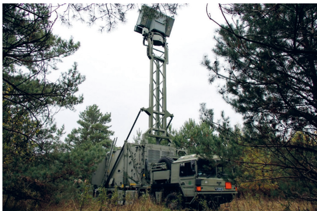
4.49 pav. | Vidutinio nuotolio taikinių aptikimo radiolokatorius TRML-3D/32
