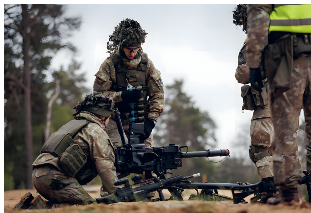
4.21 pav. | Automatinis granatsvaidis H&K GMG (Vokietija) (kalibras – 40 mm, svoris – 60,6 kg; maksimalus šūvio nuotolis – 2 200 metrų)
