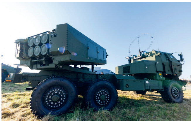
4.29 pav. | Artilerijos raketų sistema HIMARS – lengvasis daugkartinis raketų paleidimo įrenginys, skirtas šaudyti reaktyvinių šaudmenų salvėmis, itin tikslus ginklas (didžiausias galimas šaudymo nuotolis – 300 km, didžiausias greitis – 85 m/h)
