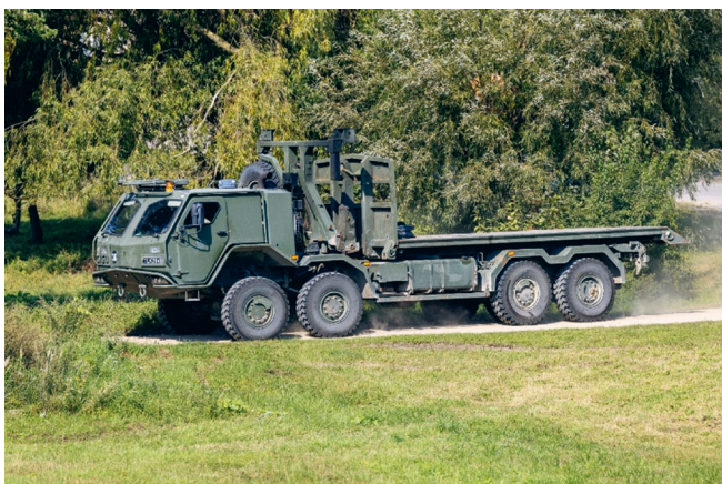
4.36 pav. | Daugiafunkcis sunkvežimis SISU E13TP, naudojamas atliekant įvairias tiekimo ir aprūpinimo užduotis; dėl didelio pravažumo ir didelės keliamosios galios sunkvežimis gali gabenti ratinę ar vikšrinę techniką ir kitus sunkius krovinius esant ekstremaliosioms sąlygoms
