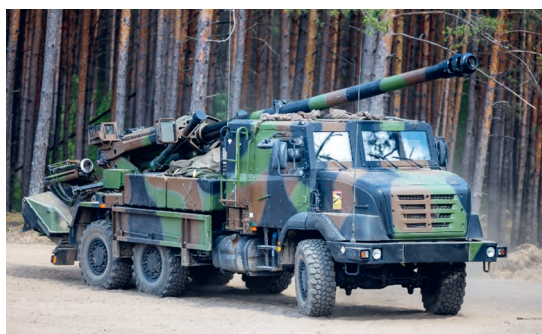
4.27 pav. | Haubica „CAESER MARK II“ (kalibras – 155 mm, šūvio nuotolis – 38 500 metrų; haubica itin manevringa, ją nesudėtinga valdyti ir aptarnauti)
