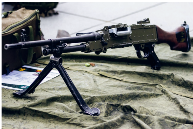
4.16 pav. | Kulkosvaidis FN MAG (Belgija) (kalibras – 7,62 mm, svoris – 11,6 kg)
