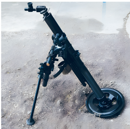
4.25 pav. | Lengvasis minosvaidis (kalibras – 60 mm, svoris – 17,3–21,3 kg; šūvio nuotolis – 100–3 130 metrų)
